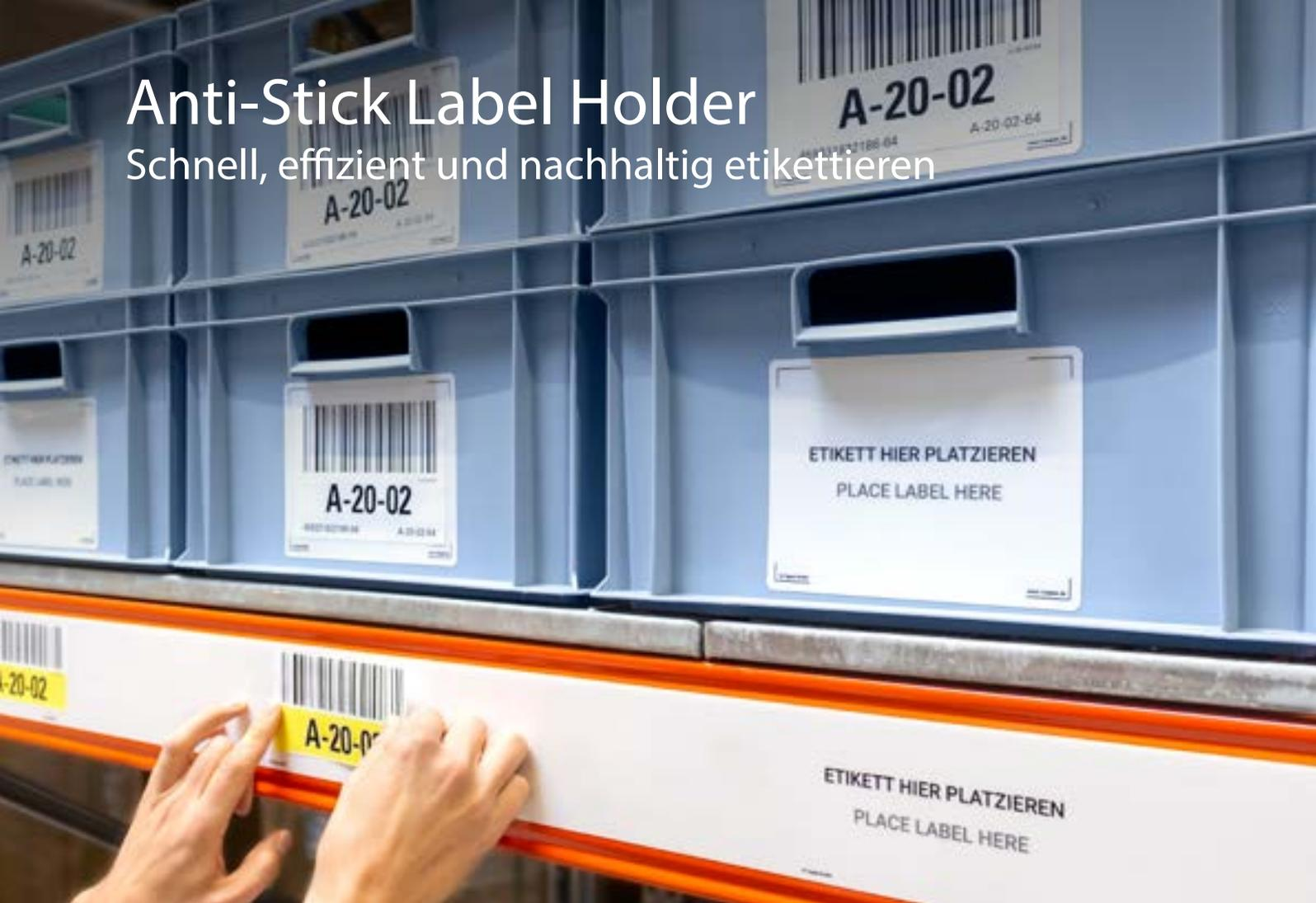
Kleberückstände alter Etiketten erwecken einen unorganisierten Eindruck und kosten Zeit und Geld. Die spezielle Anti-Stick Folie erzeugt eine Oberfläche auf der typische Papieretiketten haften, aber dennoch ohne Rückstände entfernt werden
